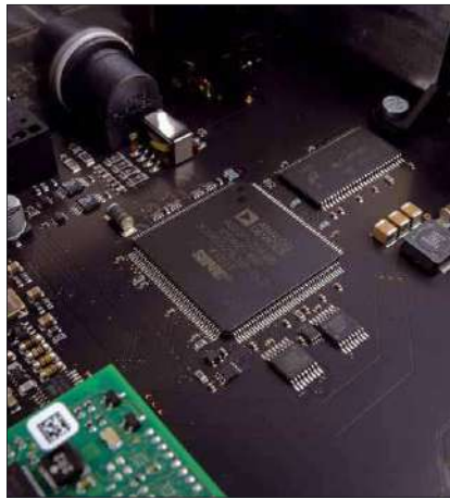
Der Analog-Devices-DSP ist ein enorm leistungsstarkes Stück Hardware, das dem DAC502 seine vielfältigen Fähigkeiten verleiht
